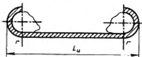
Расстояние  $l$ , мм, равно утроенному шагу крутки;  $r$  — ограничивающие отметки для стандартного испытания;  $L_u$  — эффективная длина, измеренная без натяжения, испытуемый отрезок просто расправлен.
