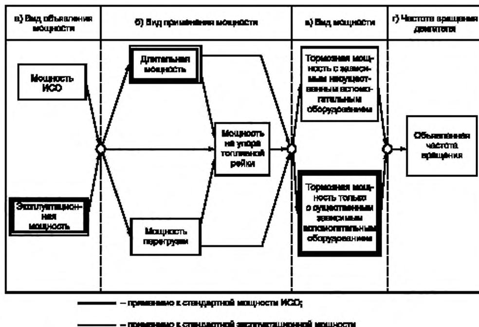
Рисунок 1 — Диаграмма, показывающая способы определения вида мощности
