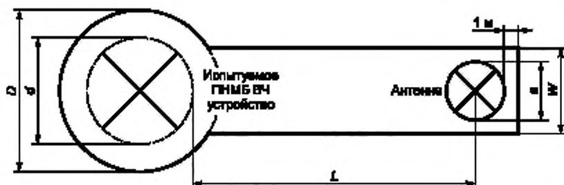
$D = d + 2$ , где  $d$  — максимальный размер испытуемого ПНМБ ВЧ устройства, м;
