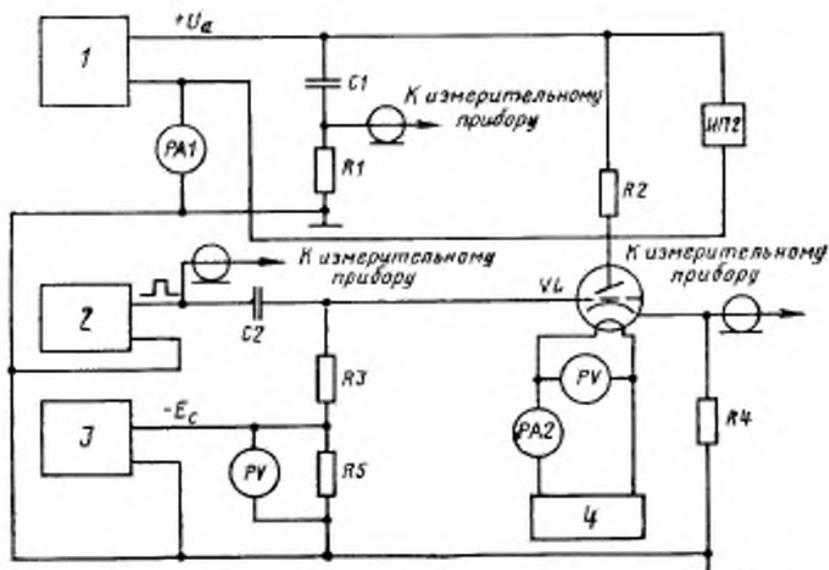
1 — источник высокого напряжения; 2 — источник напряжения сетки в импульсе;
