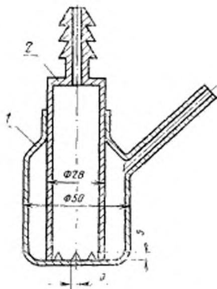
1—полиэтиленовая банка БИЛ-100; 2—цилиндр из фторопласта
