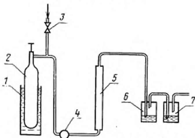
1—стакан с водой, температура 15—25 °С; 2—баллон с дихлорсиланом; 3—вентиль, Ar—аргон для продувки, избыточное давление 0,02 кПа; 4—регулятор давления; 5—ротаметр; 6—поглотитель; 7—контрольный поглотитель
