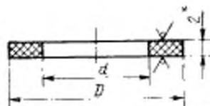
\* Для  $D_y$  1400 мм и более толщина прокладки 3 мм.
