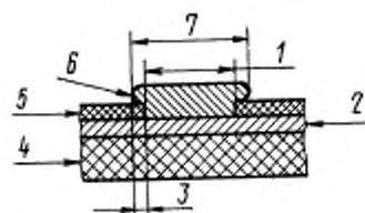
1 — ширина проводника по рабочему фотошаблону; 2 — металлическая фольга; 3 — разрастание; 4 — материал основания; 5 — резистивное покрытие; 6 — осаждение металла; 7 — ширина проводника
