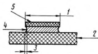
1 — ширина проводника по рабочему фотошаблону; 2 — материал основания; 3 — подравливание; 4 — проводник; 5 — органическое резистивное покрытие
