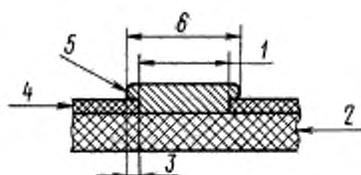
1 — ширина проводника по рабочему фотошаблону; 2 — материал основания; 3 — разрастание; 4 — резистивное покрытие; 5 — осаждение металла; 6 — ширина проводника
