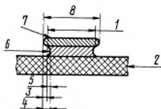
1 — ширина проводника по рабочему фотошаблону; 2 — материал основания; 3 — разрастание; 4 — нависание; 5 — подравливание; 6 — проводник; 7 — осаждение металла; 8 — ширина проводника
