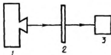
1—источник излучения (рентгеновский аппарат); 2—экран яркость которого измеряется; 3—яркометр (фотометр)
