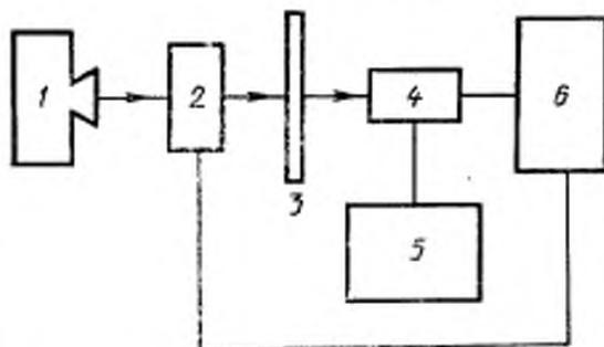
1 — рентгеновский аппарат (для осветителя); 2 — устройство для прерывания облучения экрана; 3 — экран; 4 — фотоэлектронный умножитель (ФЭУ); 5 — блок питания ФЭУ; 6 — осциллограф
