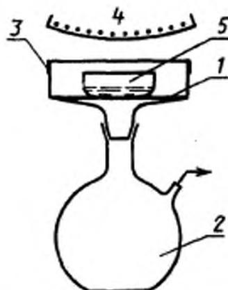
1—камера (при необходимости снабженная патрубком для продувания газом); 2—присоединяемая колба; 3—колпак; 4—инфракрасная лампа; 5—сосуд с пробой
