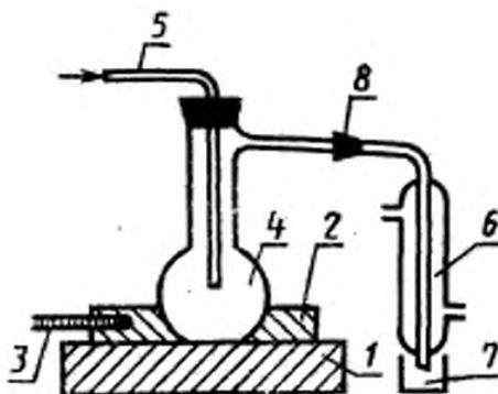
1—плитка; 2—насадка нагревательного блока; 3—термометр; 4—перегонная колба из кварцевого стекла с боковым патрубком; 5—трубка из кварцевого стекла; 6—холодильник; 7—прямник; 8—соединение на шлицах или трубка из фторопласта
