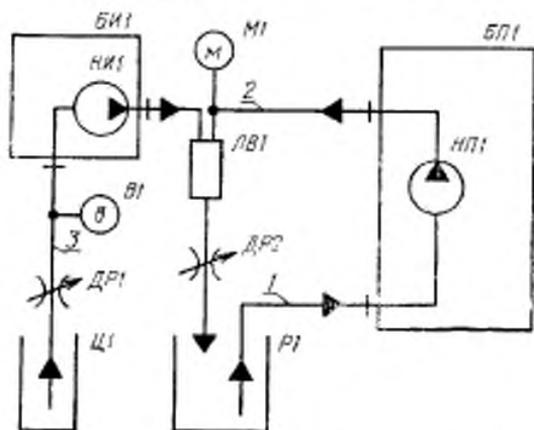
БИ1 — инфузионный блок; БП1 — перфузионный блок; ДР1, ДР2 — дроссели; М1 — манометр; НИ1 — инфузионный насос (составная часть инфузионного блока); НП1 — перфузионный насос (составная часть перфузионного блока); ЛВ1 — ловушка воздуха (составная часть выходной магистрали); Р1 — резервуар; Ц1 — мерный цилиндр; В1 — вакуумметр; 1 — входная магистраль; 2 — выходная магистраль; 3 — магистраль инфузата
