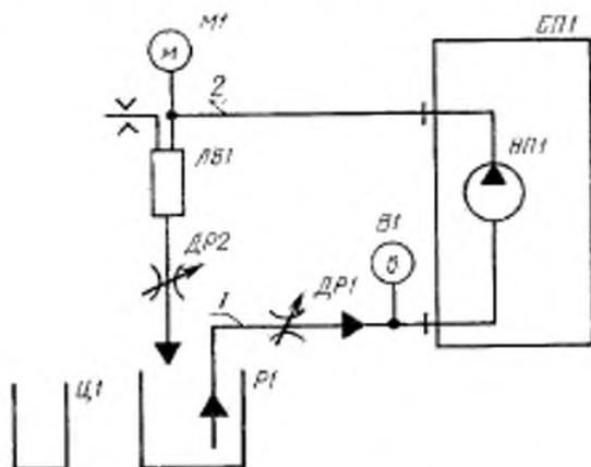
*БП1* — перфузионный блок; *В1* — вакуумметр; *ДР1*, *ДР2* — дроссели; *ЛВ1* — ловушка воздуха (составная часть выходной магистрали); *М1* — манометр; *НП1* — перфузионный насос (составная часть перфузионного блока); *Р1* — резервуар; *Ц1* — мерный цилиндр; *1* — входная кровопроводящая магистраль; *2* — выходная кровопроводящая магистраль
