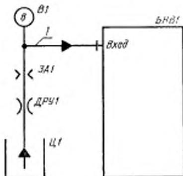
*БНВ1* — блок нормализующего воздействия; *В1* — вакуумметр; *ДРУ1* — дроссель ультрафильтрата; *ЗА1* — зажим; *Ц1* — мерный цилиндр; *1* — магистраль ультрафильтрата
