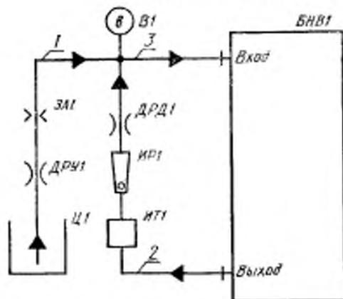
БНВ1 — блок нормализующего воздействия; В1 — вакуумметр; ДРД1 — дроссель диализата; ДРУ1 — дроссель ультрафильтрации; ЗА1 — зажим; ИР1 — измеритель расхода; ИТ1 — измеритель температуры; Ц1 — мерный цилиндр; 1 — магистраль инфузата; 2, 3 — магистрали диализата
