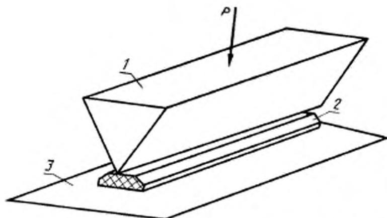
1 — трехгранная металлическая призма; 2 — образец стеклопластика; 3 — опорная плита
