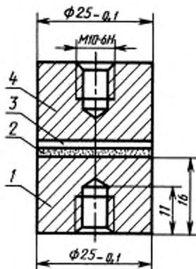
1 — образец; 2 — покрытие; 3 — клеевая прослойка; 4 — контробразец
