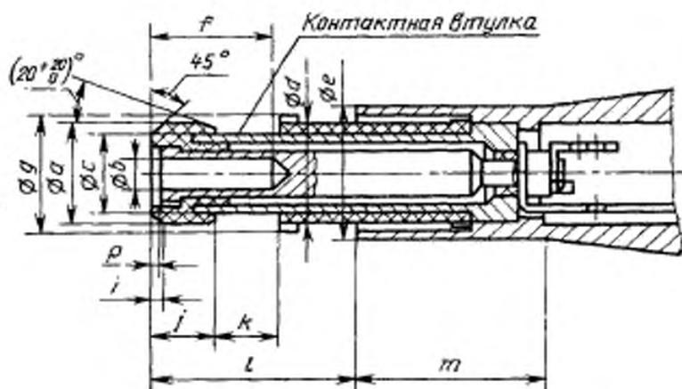
Примечание. Концы выводов под ленту 2×1 мм. Максимальный диаметр провода 0,9 мм.
