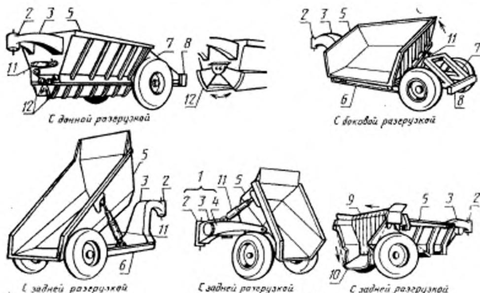
1 — тяговая рама; 2 — корпус шарнира; 3 — хобот; 4 — рычаги тяги; 5 — кузов; 6 — основная рама; 7 — задняя рама; 8 — бампер; 9 — выдвижная стенка; 10 — откидной задний борт; 11 — гидроцилиндр; 12 — затворы
