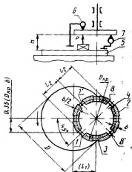
Примечание. При вращении стола, противоположно указанному на черт. 10, нагружающая сила и измерительный наконечник прибора для измерения длин  $b$  должны находиться на вертикальной прямой, проходящей через точку  $I'$ , а точка измерения прибора для измерения длин  $7$  должна занимать положение  $8'$ .
