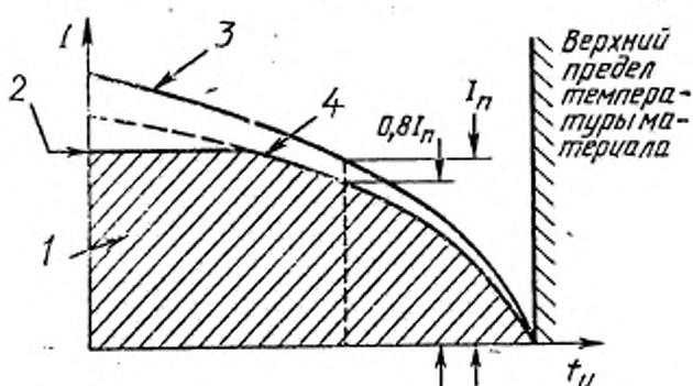
1 — допустимый рабочий диапазон; 2 — верхний предел тока, обуславливаемый действием внешних факторов, например сечением присоединяемого провода; 3 — основная кривая; 4 — скорректированная кривая
