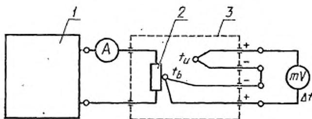
1 — стабилизированный источник питания; 2 — образец; 3 — измерительная камера
