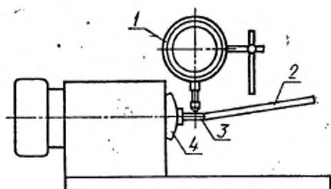
1 — цифровой индикатор 0,025 мм; 2 — проводник; 3 — контакт; 4 — высокоточный зажим
