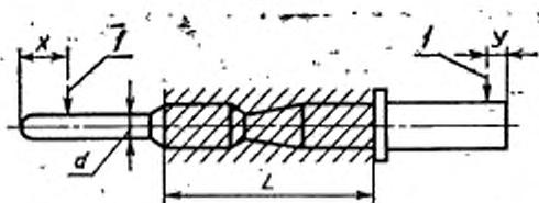
$x = 2d$ ;  $y$  — приблизительно половина расстояния между концом хвостовика и ближайшей кромкой деформированной части;  $L$  — область крепления;  $d$  — диаметр штыревого контакта;  $l$  — расположение шупа цифрового индикатора для измерения
