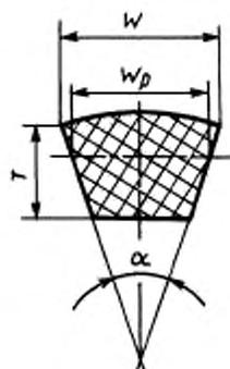
$W_p$  — расчетная ширина ремня, мм;  $W$  — ширина большего основания ремня, мм;  $T$  — высота ремня, мм;  $\alpha$  — угол клина ремня, равный  $(40 \pm 1)^\circ$
