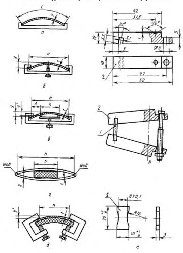
a — образец, нагруженный в двух точках;  $\delta$  — образец, нагруженный в трех точках;  $\sigma$  — образец, нагруженный в четырех точках; е – образец в виде двойного бруса; д – образец на сплошной опоре; е – образец, нагруженный с помощью рычага; I — образец; 2 — рычаг
