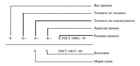
Примечание. Параметры и характеристики проката, приведенные в схеме, если они не указаны в заказе, устанавливаются изготовителем и в обозначении не приводятся.
