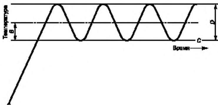
*A* — зарегистрированная температура; *B* — максимальное допустимое отклонение;
