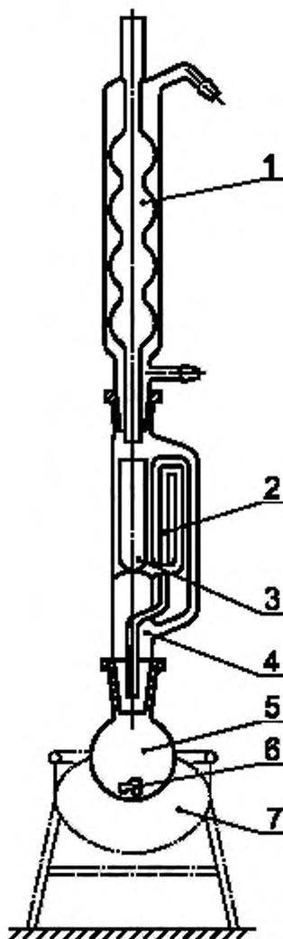
1 — холодильник шариковый; 2 — сифон; 3 — элемент фильтрующий; 4 — экстрактор Сокслета; 5 — колба круглодонная; 6 — кусочки перманентной бумаги; 7 — устройство нагрева колбы
