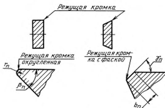
$\beta_n$  — угол заострения нормальный;  $r_n$  — радиус округления режущей кромки;  $b_n$  — ширина фаски режущей кромки;
