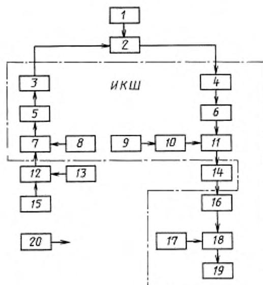
1 — источник питания входного усилителя СВЧ; 2 — входной усилитель СВЧ; 3 — согласующий трансформатор; 4, 5, 16 — развязывающие элементы (ферритовые вентили); 6, 10 — СВЧ модуляторы; 7, 11, 12 — направленные ответвители; 8, 9 — генераторы шума; 13, 15 — генераторы сигналов, имитирующих радиопомеху; 14 — полосовой фильтр; 17 — гетеродин; 18 — смеситель; 19 — измерительный прибор; 20 — измеритель СВЧ мощности
