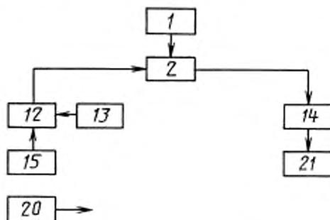
*1* — источник питания входного усилителя СВЧ; *2* — входной усилитель СВЧ; *12* — направленный ответвитель; *13* — генератор полезного сигнала; *14* — полосовой фильтр; *15* — генератор сигнала, имитирующего радиопомеху; *20* — измеритель СВЧ мощности; *21* — анализатор спектра или измерительный приемник
