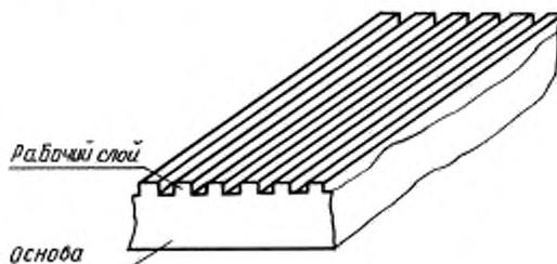
**257 формованный [неформованный] носитель (оптической) записи:**
