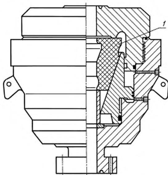
1 – управляемый контактный уплотнитель (82, 86)
