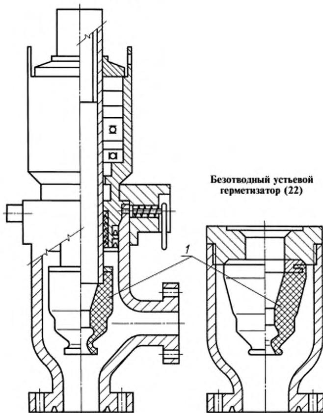
*I* — нерегулируемый контактный уплотнитель (84, 89)
