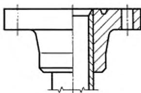
Камерная цементировочная головка (66)
