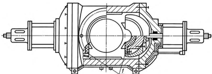
1 – управляемый контактный уплотнитель (плашки) (84, 88)
