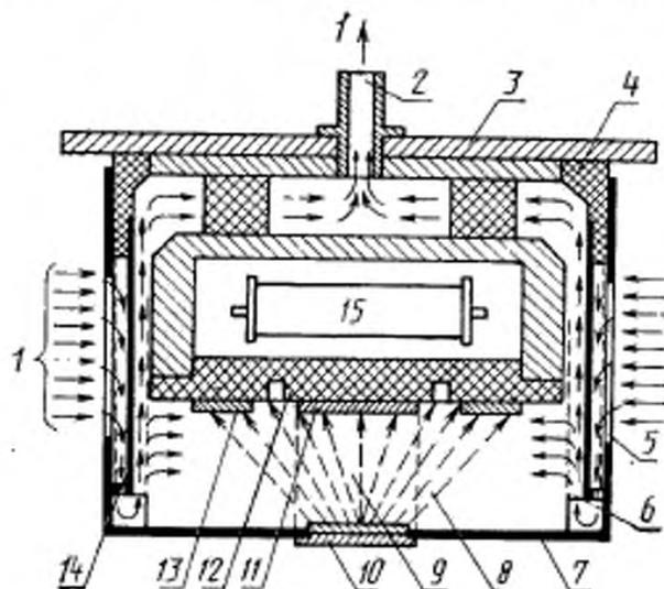
1 — контролируемая среда; 2 — штуцер всасывания контролируемой среды; 3 — основная конструкция; 4 — изолирующее кольцо; 5 — внешняя сетка; 6 — внутренняя сетка; 7 — внешний электрод; 8 — излучение; 9 — измерительный объем; 10 — источник ионизирующего излучения; 11 — измерительный электрод; 12 — изоляционный материал; 13 — защитное кольцо; 14 — ветрозащита; 15 — измерительный резистор; стрелками показано направление движения контролируемой среды при пробоотборе
