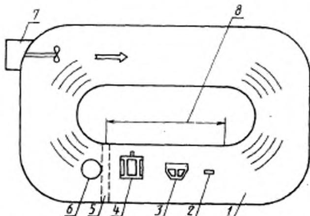
1 — аэродинамическая труба; 2 — измеритель температуры; 3 — место установки испытуемого извещателя; 4 — контрольная дозиметрическая камера; 5 — место установки нагревательного элемента; 6 — место ввода продуктов горения (аэрозоля); 7 — вентилятор; 8 — измерительный участок; стрелками показано направление движения контролируемой среды
