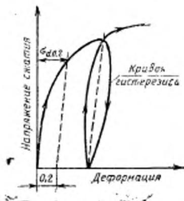
Черт. 2. Определение 0,2%-ного предела текучести при сжатии  $\sigma_{сж.0,2}$  с помощью линии, параллельной центральной линии кривой гистерезиса, на расстоянии, соответствующем 0,2% деформации
