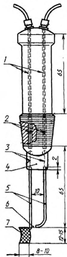
1 — изоляция для муфты; 2 — твердый слой медной проволоки, диаметром 0,7 мм; 3 — вольфрамовая проволока, диаметром 1 мм; 4 — зажимное устройство; 5 — платиновая проволока, диаметром 16 мм; 6 — зазор 2 мм; 7 — держатель образца (корзинка из платиновой проволоки, толщиной 0,5 мм)
