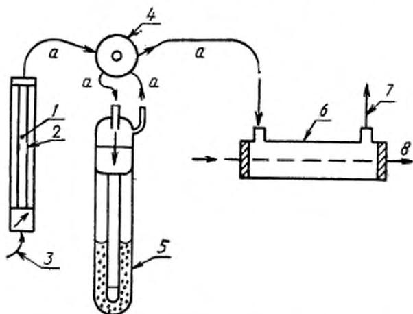
1 — реометр; 2 — игольчатый клапан; 3 — подвѣс газѣ; 4 — четырехходовой стеклянный запорный кран; 5 — реактор вместимостью 25 мл; 6 — кювета, снабженная устройством для предотвращения конденсации водяного пара; 7 — выход к вытяжному шкафу или аффективному кислотному газочистителю; 8 — ход луча в спектрометре; а — трубки соединительные, гибкие
