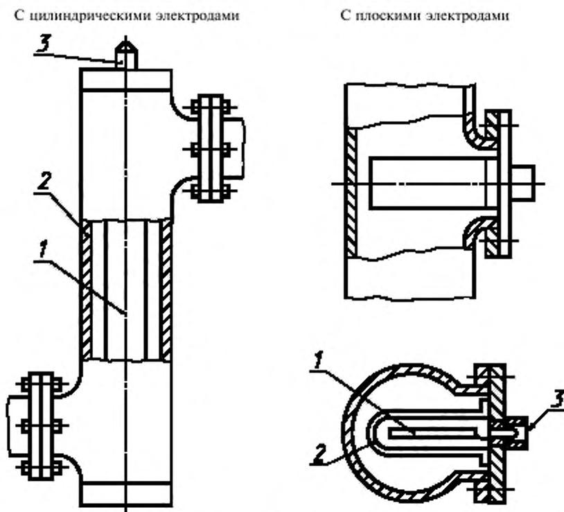
1 — внутренний электрод; 2 — внешний электрод; 3 — разъем для соединения с измерительным блоком
