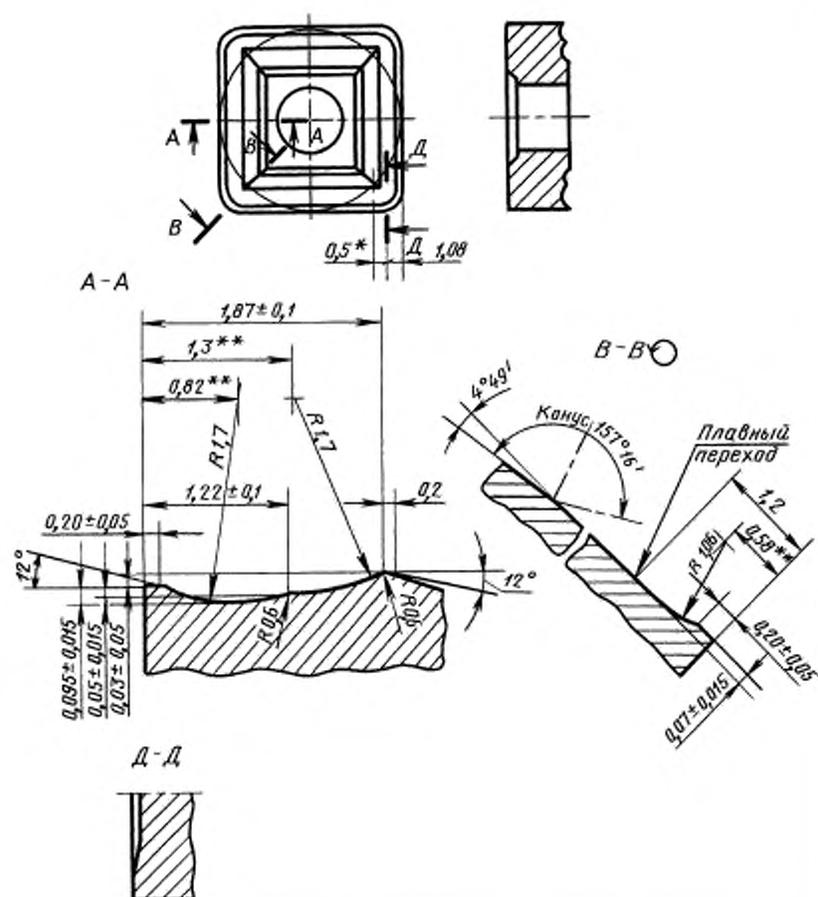
\* Переход между главным стружколомом и стружколомом при вершине выравнивается на длине 0,5 мм.
