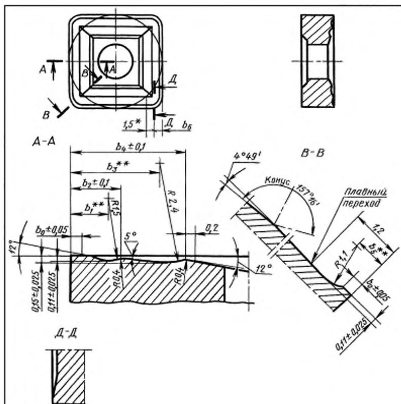
\* Переход между главным стружколомом и стружколомом при вершине выравнивается на длине 1,5 мм.
