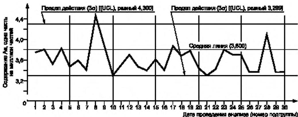
Рисунок 11 — Контрольная карта Шухарта для средних значений  $\bar{x}$  содержания мышьяка в оксиде цинка
