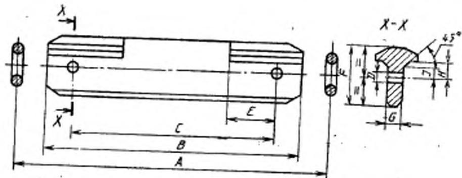
Рисунок 1 — Размеры Т-образных скребков
