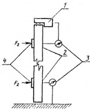
1 — коробка; 2 — полотно; 3 — измерительное устройство; 4 — металлическая пластина
