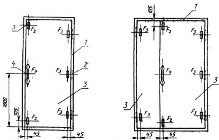
1 — коробка; 2 — петли; 3 — полотно; 4 — заправляющий прибор; 5 — металлическая пластина
