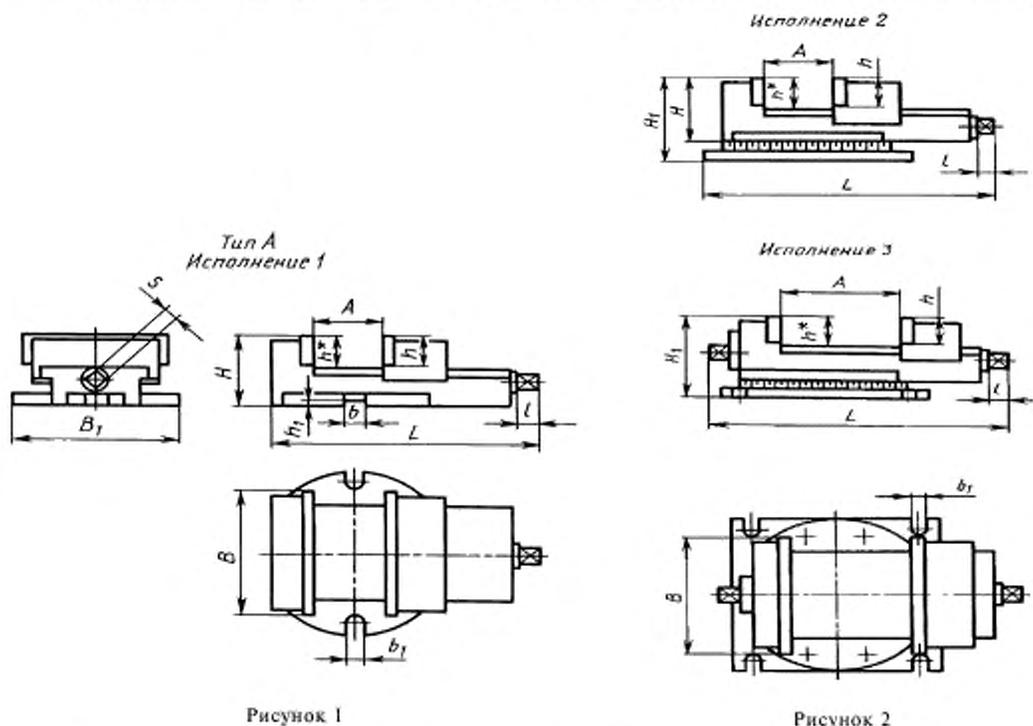
Примечание — Рисунки 1 и 2 не определяют конструкции тисков; размер  $h^* = h$ ,
