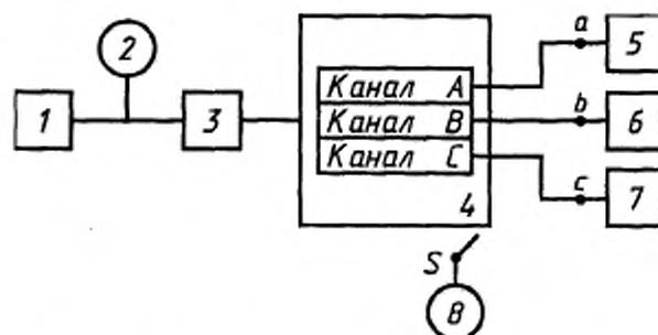
1 — низкочастотный генератор (В.1.2.2); 2, 8 — вольтметры (В.1.2.1.3); 3 — согласующее звено (В.1.2.14); 4 — УЗЧ; 5 — эквивалент нагрузки головного телефона канала А (В.1.2.8); 6 — эквивалент нагрузки головного телефона канала В (В.1.2.8); 7 — эквивалент нагрузки тактильного вибратора канала С (В.1.2.9); 8 — переключатель; а, б, с — точки подключения вольтметра 8
