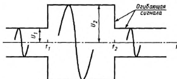
$U_1$  — напряжение до подачи скачка напряжения;  $U_2$  — напряжение после подачи скачка напряжения;  $(U_2 - U_1)$  — амплитуда скачка напряжения;  $t_1$  — момент времени подачи скачка;  $t_2$  — момент времени окончания скачка
