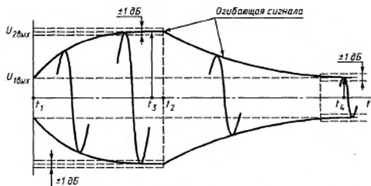
$U_{1\max}$  — установившееся напряжение до подачи и после снятия скачка напряжения;  $U_{2\max}$  — установившееся напряжение после подачи скачка напряжения;  $t_1$  — момент времени подачи скачка;  $t_2$  — момент времени снятия скачка;  $t_3$ ,  $t_4$  — моменты времени, когда огибающие сигнала отличаются от установившихся значений напряжений  $U_{2\max}$  и  $U_{1\max}$  на 1 дБ
