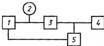
1 — генератор модулированных скачков сигнала (В.1.2.15); 2 — вольтметр (В.1.2.1.3); 3 — УЗЧ; 4 — эквивалент нагрузки (В.1.2.8); 5 — осциллограф (В.1.2.16)
