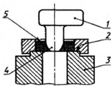
1 — СА; 2 — передняя плоскость имитатора уха; 3 — имитатор уха; 4 — ушной вкладыш СА; 5 — герметизирующее и фиксирующее уплотнение
