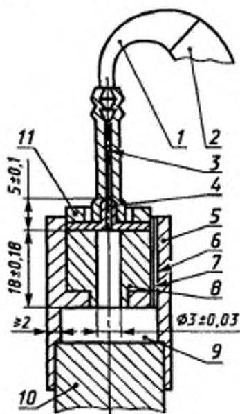
1 — звукопровод; 2 — СА; 3 — трубка; 4 — наконечник; 5 — трубчатое соединительное устройство; 6 — капиллярная трубка диаметром 0,6 мм и длиной не менее 12,5 мм; 7 — провод диаметром 0,5 мм; 8 — эквивалент ушного вкладыша; 9 — полость диаметром 18—21 мм (эффективный объем  $2 \text{ см}^3 \pm 1 \%$ ); 10 — микрофон, градуированный по давлению; 11 — герметизирующее уплотнение и упор для трубчатого соединительного устройства
