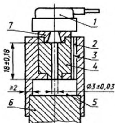
1 — испытуемый телефон; 2 — капиллярная трубка диаметром 0,6 мм и длиной не менее 12,5 мм, предназначенная для выравнивания статического давления; 3 — провод диаметром 0,5 мм; 4 — эквивалент ушного вкладыша; 5 — полость диаметром 18—21 мм (эффективный объем  $2 \text{ см}^3 \pm 1 \%$ ); 6 — микрофон, градуированный по давлению; 7 — герметизирующее уплотнение и опора выступа телефона
