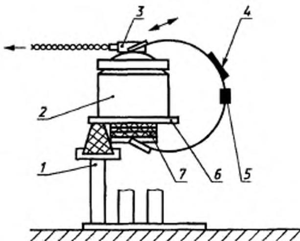
1 — опора; 2 — механическая камера связи; 3 — костный вибратор; 4 — оголовье для крепления костного вибратора; 5 — демпфер; 6 — основание механической камеры связи; 7 — прокладки из пористого материала, обеспечивающие статическую силу прижима 2,0 Н
