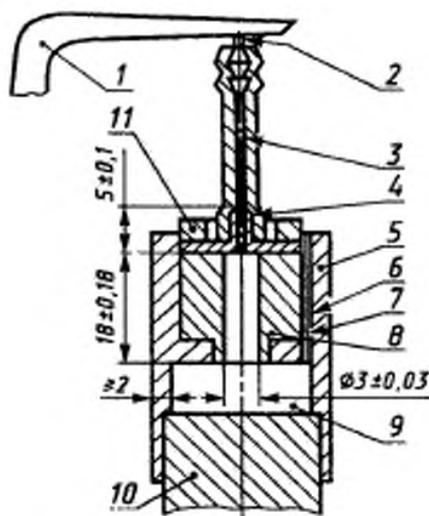
1 — заушник; 2 — патрубок; 3 — трубка; 4 — наконечник; 5 — трубчатое соединительное устройство; 6 — капиллярная трубка диаметром 0,6 мм и длиной не менее 12,5 мм, предназначенная для выравнивания статического давления; 7 — провод диаметром 0,5 мм; 8 — эквивалент ушного вкладыша; 9 — полость диаметром 18—21 мм (эффективный объем  $2 \text{ см}^3 \pm 1 \%$ ); 10 — микрофон, градуированный по давлению; 11 — герметизирующее уплотнение и упор для трубчатого соединительного устройства
