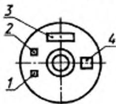
1 — зона расположения обозначения номинального модуля полного электрического сопротивления; 2 — зона расположения обозначения типа частотной характеристики; 3 — зона расположения товарного знака; 4 — зона расположения даты изготовления
