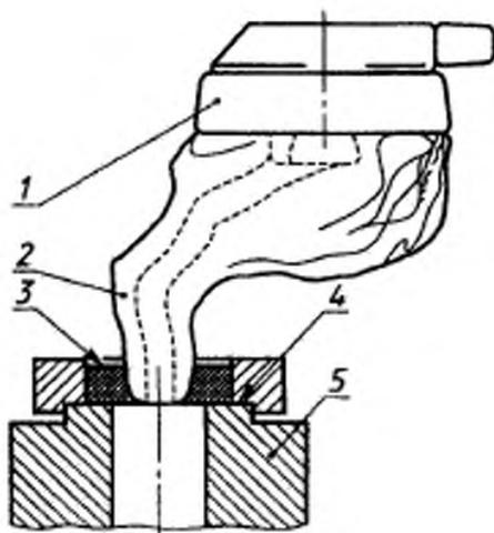
1 — телефон СА; 2 — индивидуальный ушной вкладыш; 3 — герметизирующее и фиксирующее уплотнение; 4 — опорная плоскость имитатора уха; 5 — имитатор уха
