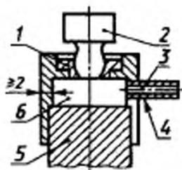
1 — герметизирующее уплотнение для СА; 2 — внутриушной СА; 3 — провод диаметром 0,5 мм; 4 — капиллярная трубка диаметром 0,6 мм и длиной не менее 12,5 мм; 5 — микрофон, градуированный по давлению; 6 — полость диаметром 18—21 мм (эффективный объем  $2 \text{ см}^3 \pm 1 \%$ )
