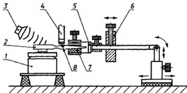
1 — механическая камера связи; 2 — СА; 3 — источник звука;
