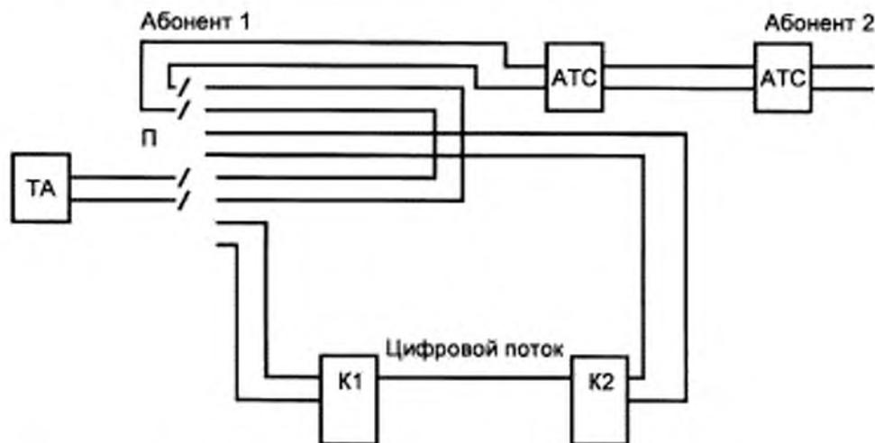
П — переключатель; ТА — телефонный аппарат; АТС — автоматическая телефонная станция; К 1(2) — оцениваемый кодек 1(2).
