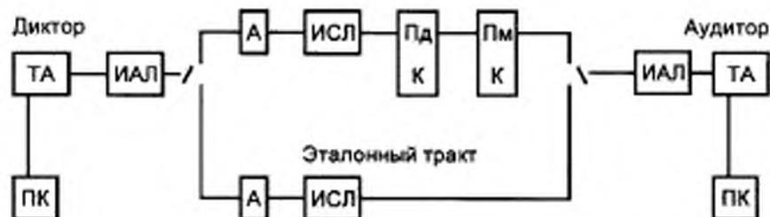
ТА — телефонный аппарат; ИАЛ — искусственная абонентская линия; ПК — питающий комплект; А — аттенюатор; ИСЛ — искусственная соединительная линия; Пд К — передающая часть оцениваемого кодека; Пм К — приемная часть оцениваемого кодека.
