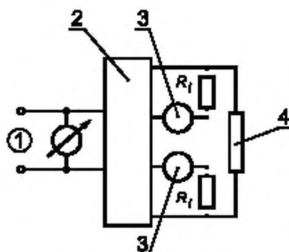
1 — сеть; 2 — испытуемый ПРА; 3 — измерительное устройство; 4 — лампа
