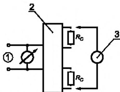
1 — сеть; 2 — испытуемый ПРА; 3 — измерительное устройство
