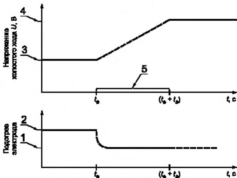
1 —  $\geq I_{0n}$  до зажигания лампы; 2 —  $t_0$  до  $t_0$ ; 3 —  $U$  до  $t_0$ ; 4 —  $U$  после  $t_0$ ; 5 — продолжительность переходного периода  $t_5 \geq 100$  мс
