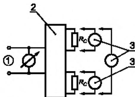
1 — сеть; 2 — испытуемый ПРА; 3 — измерительное устройство
