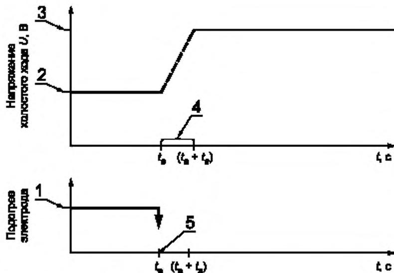
1 —  $t_0$  до  $t_0$ ; 2 —  $U$  до  $t_0$ ; 3 —  $U$  после  $t_0$ ; 4 — продолжительность переходного периода  $t_4 = 100$  мс, не более; 5 — подогрев электрода прекращается в момент  $t_0$
