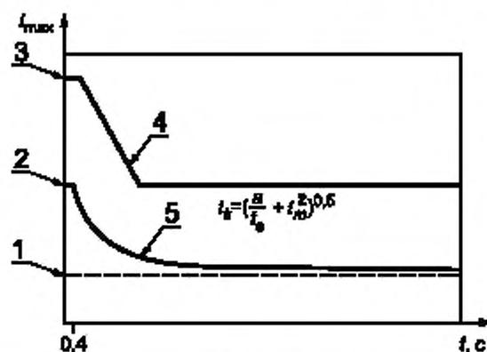
1 — абсолютный минимум  $i_0$ ; 2 —  $i_0$  при  $t_p = 0,4$  с; 3 — эффективный ток предварительного подогрева; 4 — максимальный эффективный ток предварительного подогрева в любой момент времени  $t$ ; 5 — предел минимального эффективного тока предварительного подогрева за время  $t_p$
