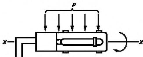
Наибольшая площадь проекции светильника в данном примере — это вид сбоку. Светильник поворачивают вокруг оси  $x-x$  на  $180^\circ$  в течение 10 мин.
