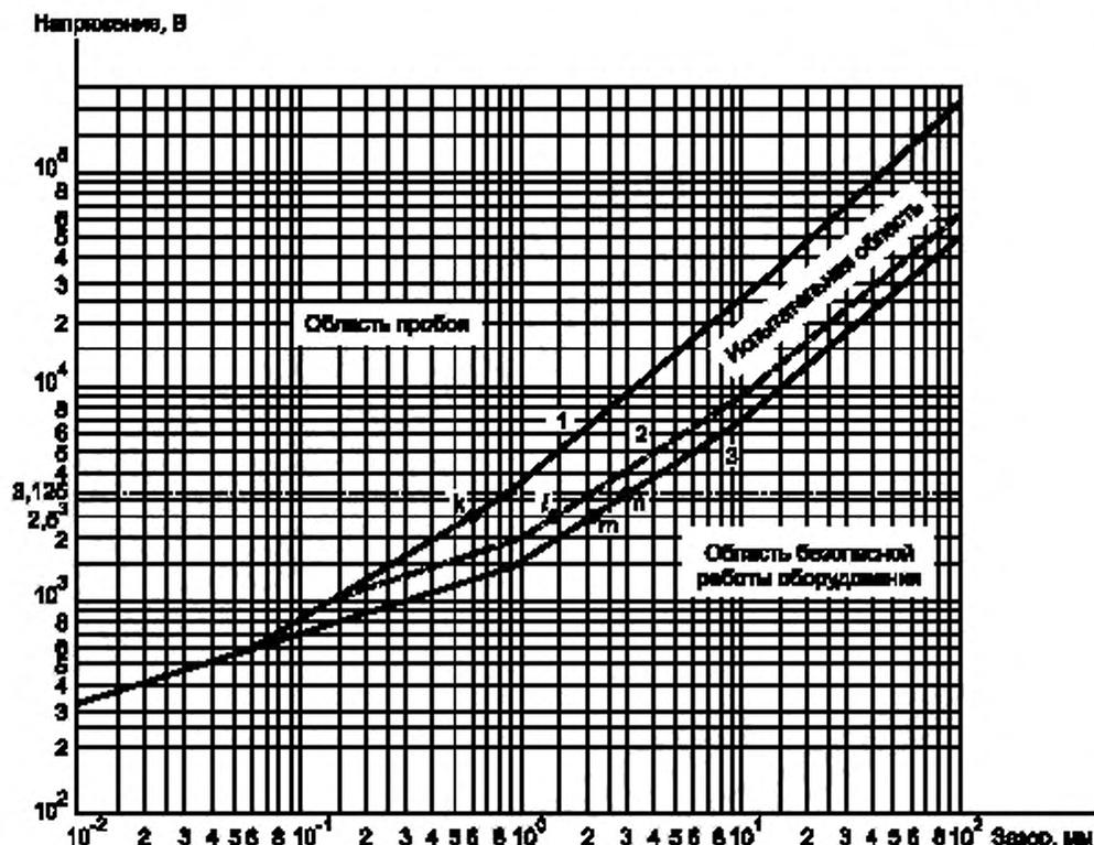
1 — однородная конструкция, испытательное напряжение частотой 50/60 Гц и импульсное «стандартное» испытательное напряжение 1,2/50 мкс; 2 — неоднородная конструкция, импульсное «стандартное» испытательное напряжение 1,2/50 мкс (только импульсное перенапряжение); 3 — неоднородная конструкция, испытательное напряжение частотой 50/60 Гц (рабочее напряжение без импульсного перенапряжения)
