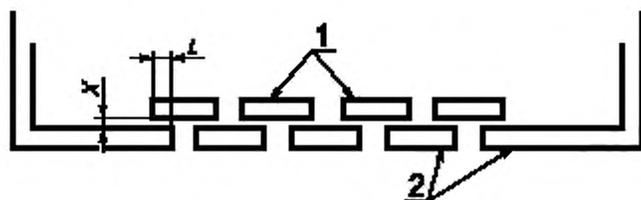
$X$  — высота, мм;  $L$  — двойная высота  $X$ , но не менее 25 мм; 1 — пластины отражателя (может быть расположен под днищем кожуха); 2 — днище кожуха
