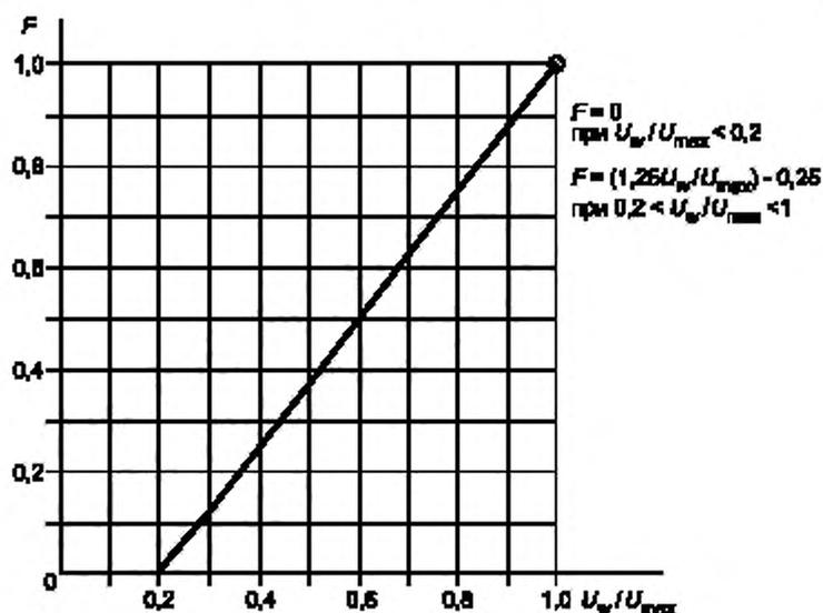
Рисунок D.1 — Коэффициент интерполяции  $F$  для расчета зазоров**D.7 Зазоры в однородной конструкции****D.7.1 Общие положения**
