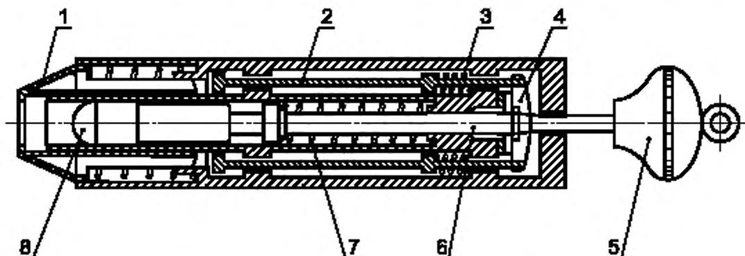
1 — подпружиненный возвращаемый конус; 2 — стержень спускового механизма; 3 — пружина спускового механизма;
