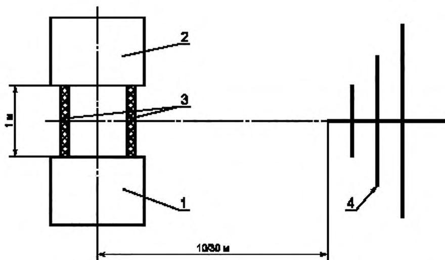
1 — оборудование; 2 — стандартная нагрузка; 3 — сварочный кабель; 4 — измерительная антенна
