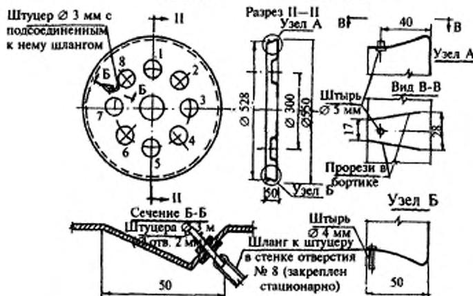
Рисунок 4 — Пластина с отверстиями к кожуху вентилятора
