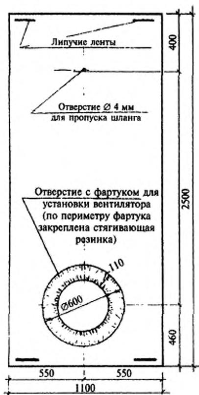
Рисунок 2 — Воздухонепроницаемое полотно
