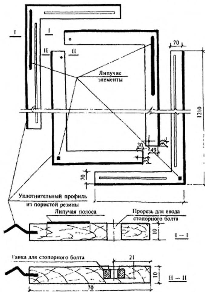
Рисунок 1 — Элементы раздвижной деревянной рамы
