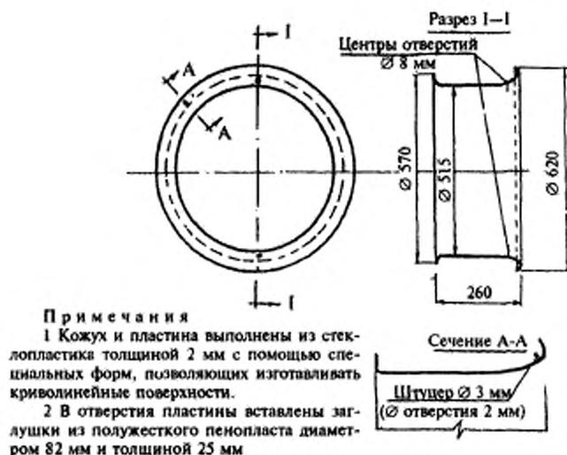
Рисунок 3 — Кожух вентилятора
