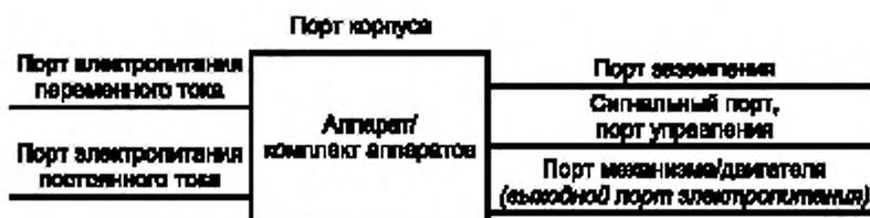
Рисунок 3 — Примеры портов аппарата / комплекта аппаратов
