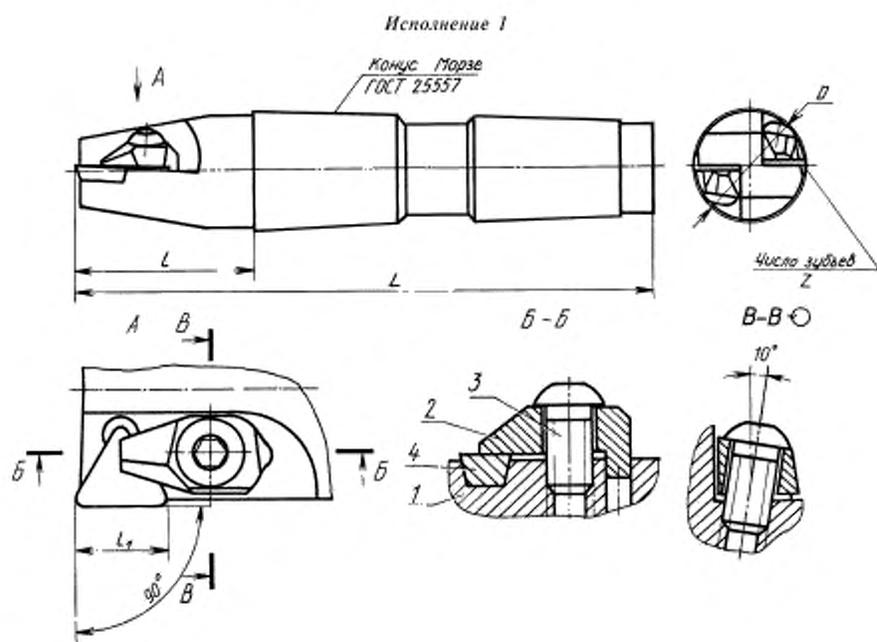
1 — корпус; 2 — прихват (кол.  $z$ ); 3 — винт (кол.  $z$ ); 4 — пластина (кол.  $z$ )
