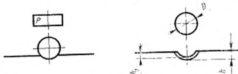
3.2. Нагрузки  $P$  и  $P_1$  могут прилагаться как в одной и той же точке (повторно), так в разных точках испытуемой поверхности образца.
