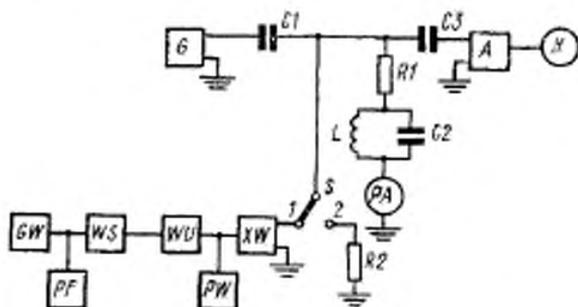
*GW*—генератор СВЧ мощности; *PF*—частотомер; *WS*—ферритовый вентиль; *G*—генератор переменного тока; *WU*—переменный аттенюатор; *PW*—измеритель мощности; *XW*—измерительная диодная камера; *R2*—калибровочный резистор; *C1*, *C3*—разделительные конденсаторы; *R1*—добавочный резистор; *L*, *C2*—резонансный контур; *A*—усилитель переменного тока; *H*—измерительный прибор; *PA*—миллиамперметр; *S*—переключатель.
