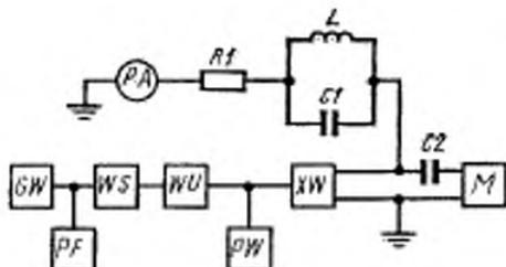
GW—генератор СВЧ мощности; PF—частотомер; WS—ферритовый вентиль; WU—переменный аттенюатор; R1—дополнительный резистор; PW—измеритель мощности; XW—измерительная диодная камера; L, C1—резонансный контур; C2—разделительный конденсатор; M—мост переменного тока; PA—миллиамперметр
