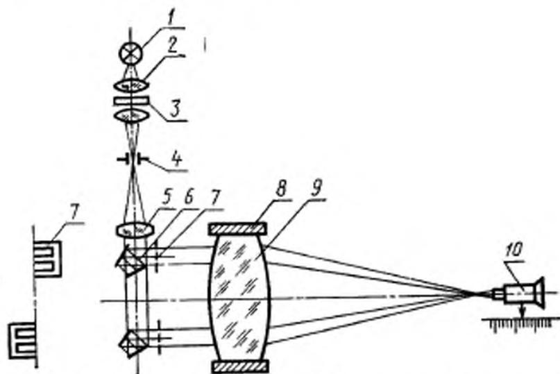
1—источник света; 2—конденсор; 3—светофильтр; 4—раздвижная щель; 5—коллиматор; 6—пентагоновый отражатель; 7—пара параллельных щелей; 8—объективодержатель; 9—испытываемый объектив; 10—микроскоп.
