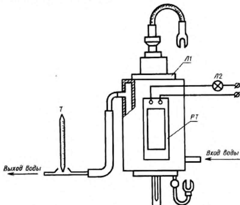
Л1—игнитрон; Л2—сигнальная лампа; РТ—реле тепловой защиты;
