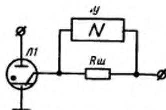
$Л1$ —испытываемый ионитрон;
