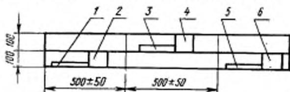
1, 3, 6 — образцы для определения предела прочности при растяжении вдоль волокон; 2, 4, 5 — образцы для определения плотности и влажности.
