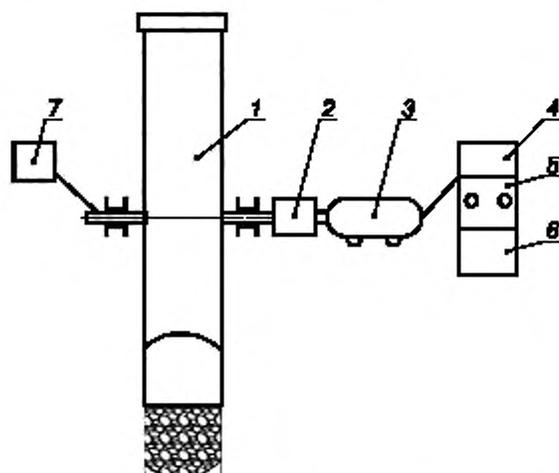
1 — барабан; 2 — редуктор; 3 — двигатель; 4 — преобразователь частоты; 5 — пульт управления;
